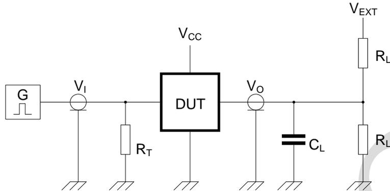
图4 测试开关时间的测试电路
