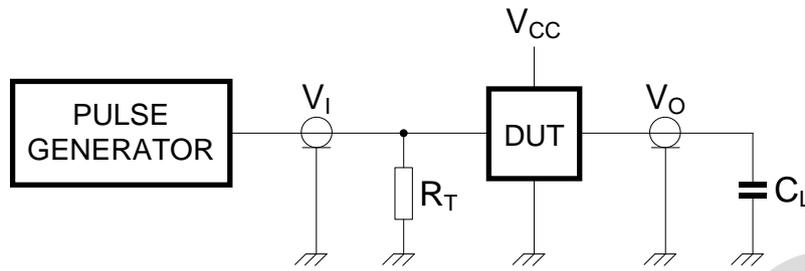
图4 测试开关时间的测试电路
