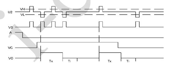
图 3 不可重复触发方式波形
