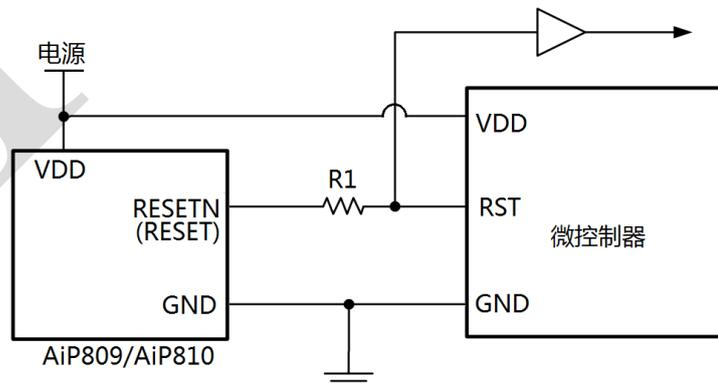
在设计 R1 的取值时, 必须考虑微控制器 RST 端口的输出驱动能力。推荐使用 4.7K $\Omega$ , 该取值可适应大部分条件的需求。
