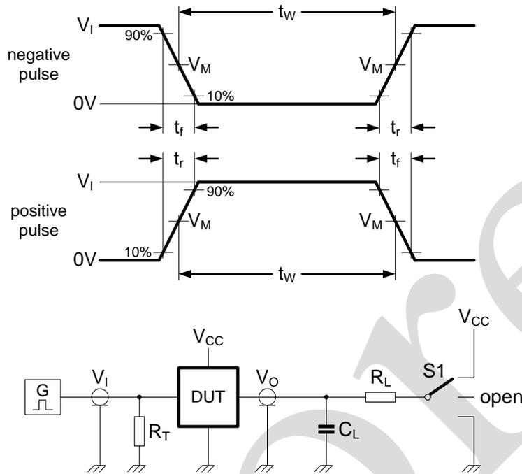
图5 测试开关时间的测试电路
