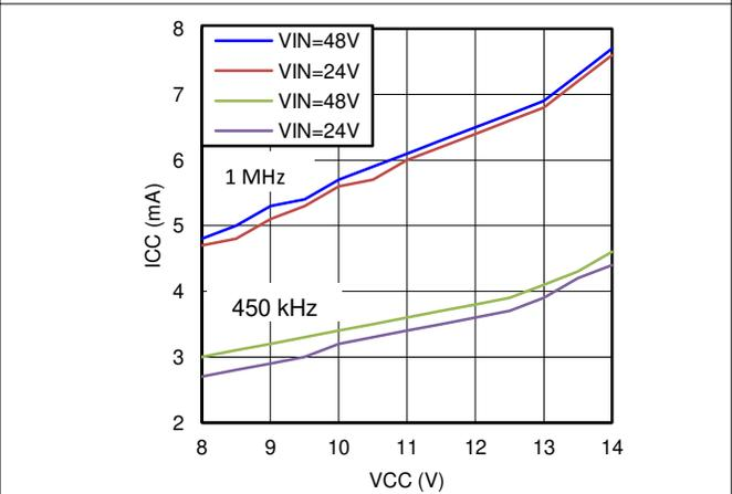
图 6-4.  $I_{CC}$  vs External  $V_{CC}$
