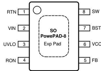
图 5-1. 8-Pin SO PowerPAD DDA Package Top View
