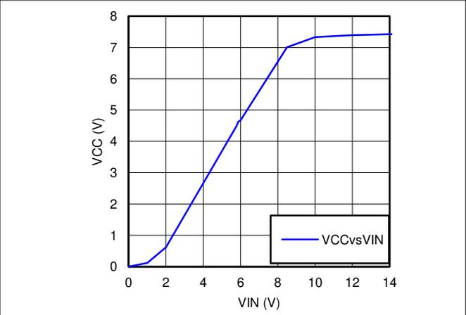
图 6-2.  $V_{CC}$  versus  $V_{IN}$
