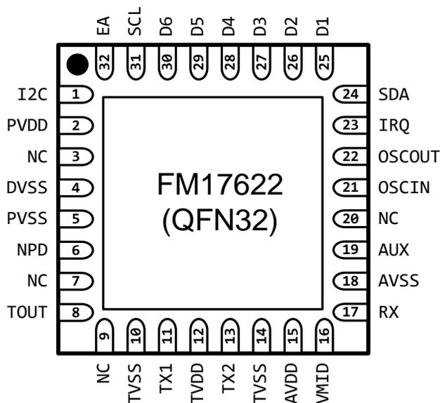
图 1-1 FM17622 QFN32 封装引脚图 (TOP VIEW)
