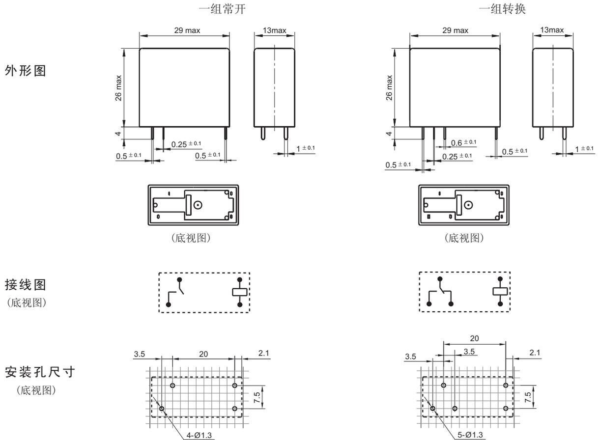
备注: (1) 产品部分外形尺寸未注尺寸公差, 当外形尺寸 $\leq 1\text{mm}$ , 公差为 $\pm 0.2\text{mm}$ ; 当外形尺寸在 $(1 \sim 5)\text{mm}$ 之间时, 公差为 $\pm 0.3\text{mm}$ ; 当外形尺寸 $> 5\text{mm}$ , 公差为 $\pm 0.4\text{mm}$ ;
