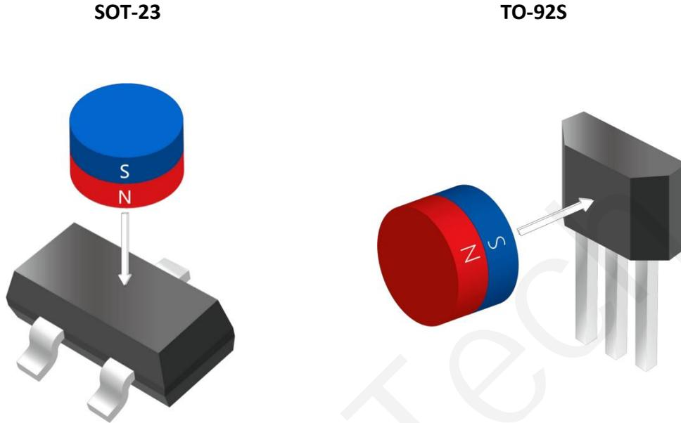
如上图，DH3144 产品对磁感线由芯片底部垂直向芯片顶部穿过的磁场和由芯片顶部垂直向芯片底部穿过的磁场都敏感。以丝印面为正面，DH3144，SOT-23 封装对 N 极磁场敏感；TO-92S 封装对 S 极磁场敏感。
