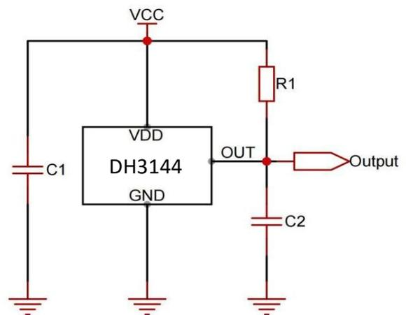
注: R1 推荐使用  $10\text{k}\Omega$ 。C1 推荐使用  $100\text{nF}$ , C2 推荐使用  $1\text{nF}$ , 可有效滤除电源和信号对地的噪音,同时可有效降低芯片被静电击穿的风险。
