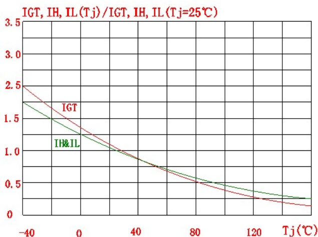
FIG. 6: 门极触发电流, 维持电流, 擎住电流与结温状态图
